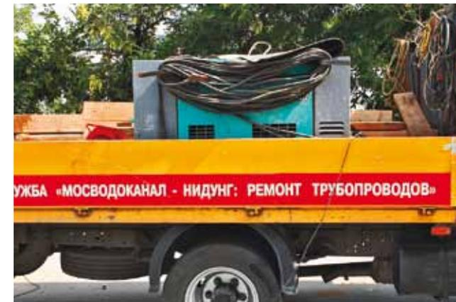
Массивный генератор с автономным двигателем всегда в кузове – к нему подключают сварку и прочий инструмент
