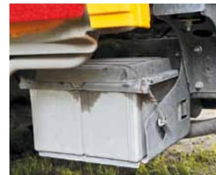
Вместо потерянной пружины крышку аккумуляторов держит проволока
