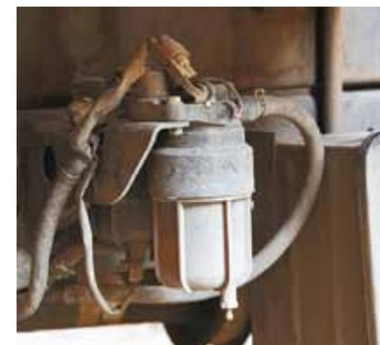
Топливный фильтр-сепаратор защищает дорогую аппаратуру от воды
