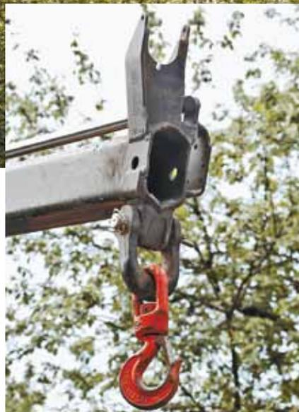
При работе в колодцах к шарнирно подвешенному гаку крепят стропы
