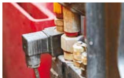
При длительной работе электроклапан может перегреться и выйти из строя
